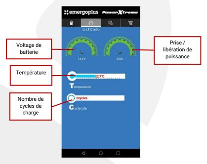
L'info UITC indique 2 "mètres", à gauche la tension de la batterie et à droite le courant. Cela peut être le courant de charge ou le courant tiré de la batterie. Si la batterie est connectée à un chargeur mais que l'alimentation est demandée par les utilisateurs en même temps, la différence sera
