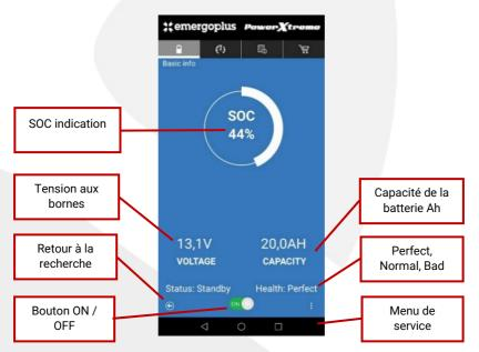
SOC signifie "État de charge" ou l'état de charge de la batterie. En dessous, la tension et la capacité de la batterie sont indiquées. À "STATUS", il est indiqué si la batterie est en cours de charge (chargement) ou déchargée (décharge) ou si la batterie est en veille.
