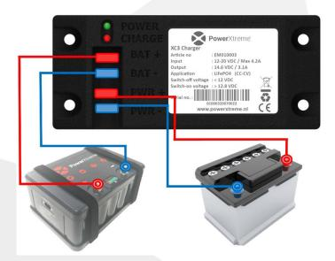
Batterie rechargeable Batterie source, démarrer la batterie or dynamo
