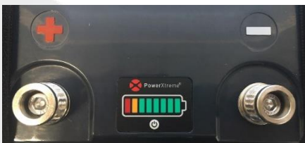
Figure 2. Différence de diamètre des pôles + et -
