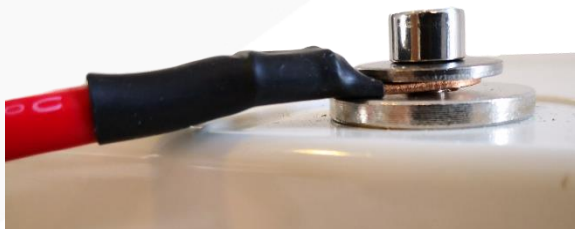
Figuur 3. FOUT! Losse verbinding door toepassing van te lang bout
